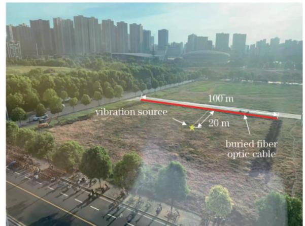
图 5 现场实验的场地布设示意图
