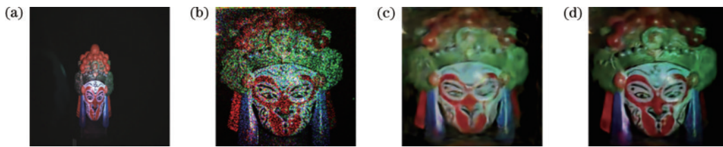
图9 实际拍摄菲涅耳全息图重建验证。(a)原始图像;(b)S-FFT重建像;(c)U-Net重建像;(d)CHR-Net重建像
