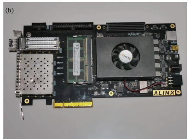
图 5 SPAD 激光通信实验。(a) 激光通信实验装置原理图; (b) 收发一体功能的 FPGA 模块
