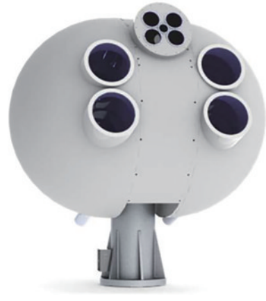
图 3 LLGT 地面终端望远镜具有 4 个 10 cm 口径的发射天线和 4 个 40 cm 口径的接收天线,共同安装于一个带有温控玻璃纤维外壳的万向架上 [34]
