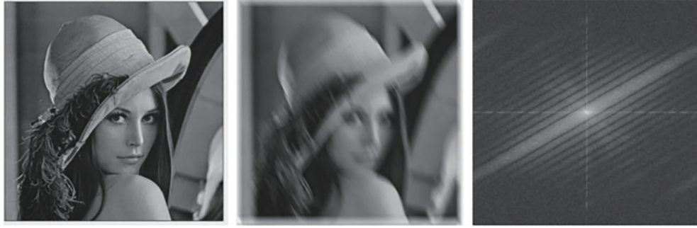
图 3 Lena 图像(左)、运动模糊图像(中)和模糊图像的频谱图(右)
