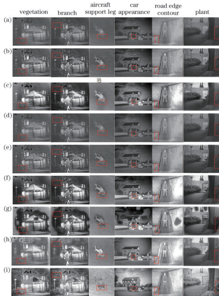
图 7 6 个场景不同算法的融合结果。(a) ADF; (b) MGFF; (c) CNN; (d) FPDE; (e) MLEPF; (f) HMSD_GF; (g) DTF_SR; (h) IFEVIP; (i) 所提方法
