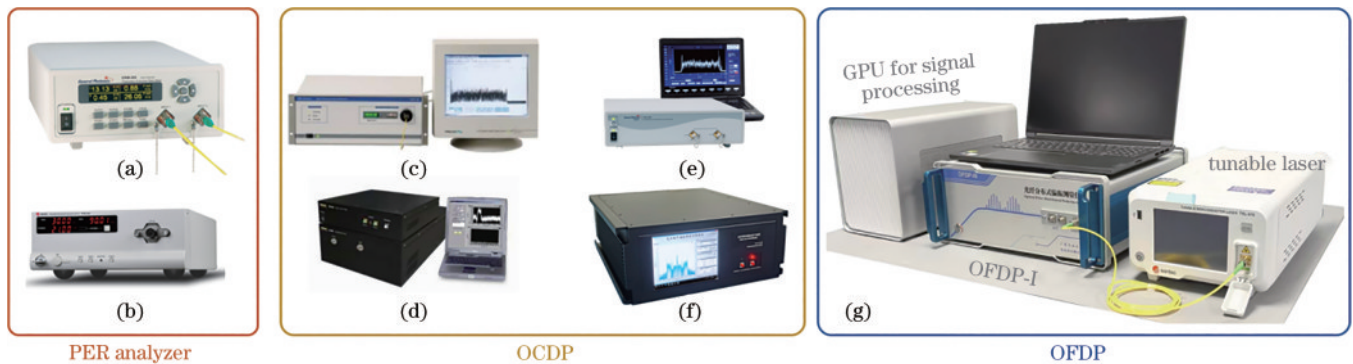
图 12 典型光纤偏振测试商用仪器。(a)美国 Luna 公司 ERM-202 型消光比测试仪；(b)日本 Santec 公司 PER-340 消光比测试仪；(c)法国 Photonics 公司 WIN-P400 型分布式偏振测试仪；(d)韩国 FiberPro 公司 ICD800 型分布式偏振测试仪；(e)美国 Luna 公司 PXA-1000 型分布式偏振测试仪；(f)哈尔滨工程大学 OCDP 型分布式偏振测试仪；(g)广东工业大学 OFDP-I 型光频域偏振计
