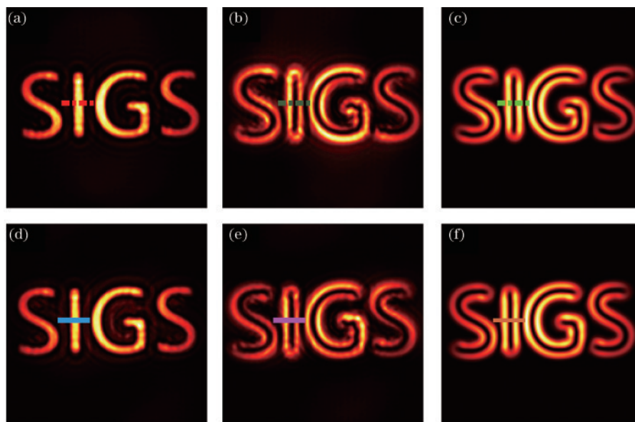
图 8 FZA 和 SZA 重建对比。(a)~(c) FZA 采用 H, H_S, H_{LG,S} 重建的强度；(d)~(f) SZA 采用 H_S, H, H_{LG} 重建的强度 Fig. 8 Comparison of FZA and SZA reconstructions. (a)~(c) Intensity of FZA reconstructed images with H, H_S, H_{LG,S} ; (d)~(f) intensity of SZA reconstructed images with H_S, H, H_{LG}
