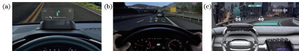
图 4 三种 HUD 原理 [18] 。(a)C-HUD; (b)W-HUD; (c)AR-HUD
