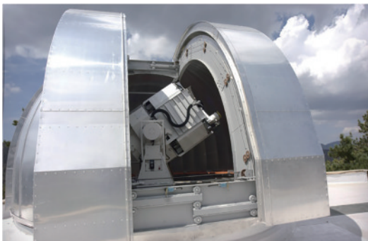
图 4 加利福尼亚州 1 m 口径光学地面站
