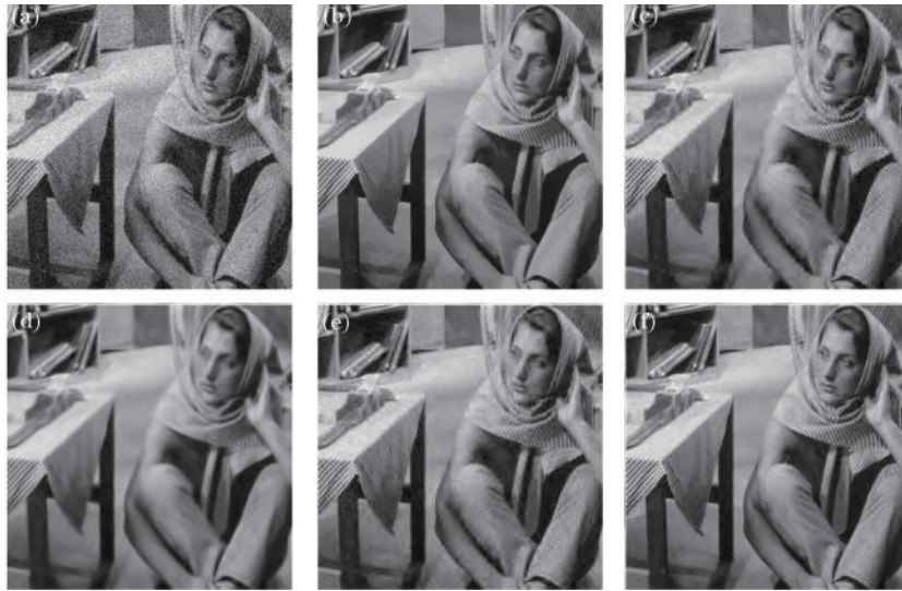
图 7 含噪强度 \sigma=30 的 Barbara 去噪图像。(a)含噪强度 30 的 Barbara;(b)文献[2]中的方法 (29.76 dB, 92.67%);(c)文献[8]中的方法(25.69 dB, 84.88%);(d)文献[13]中的方法(24.71 dB, 81.04%);(e)文献[14]中的方法(26.11 dB, 85.48%);(f)所提方法(29.79 dB, 92.71%)
