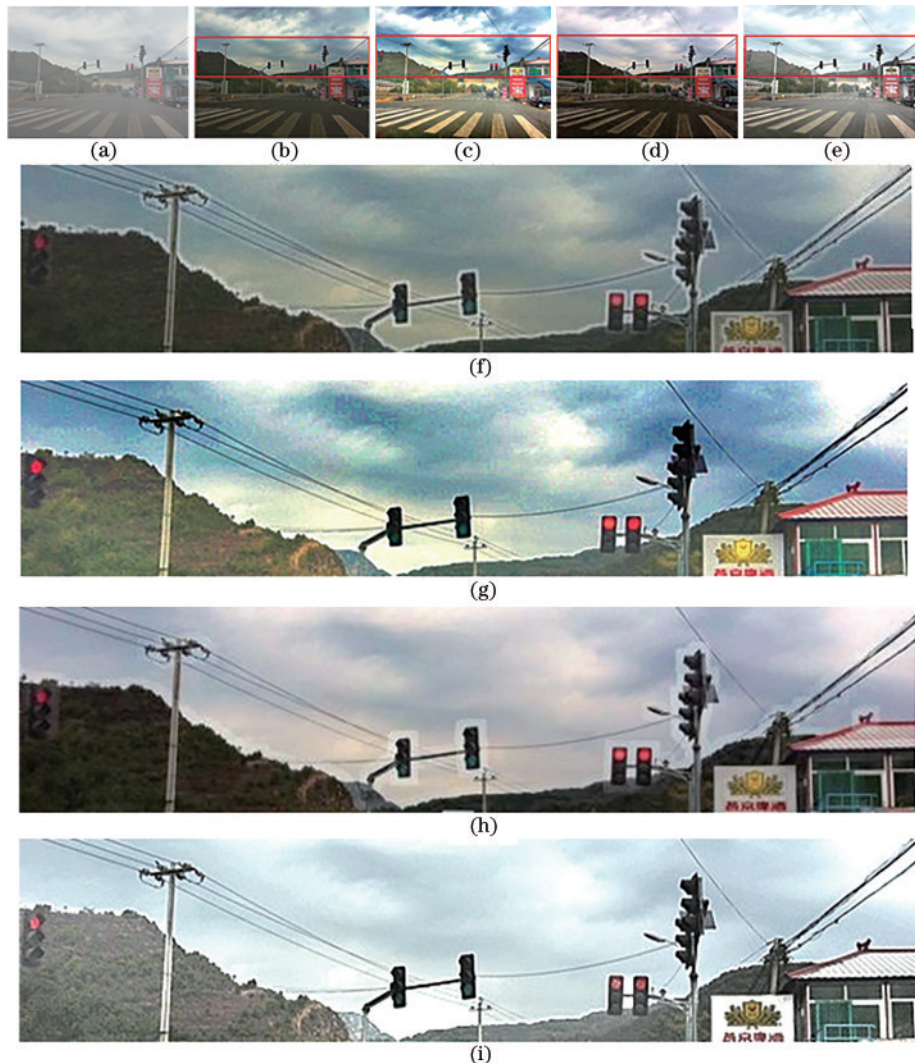
图 5 亮度融合方法去雾比较。(a)原始含雾图像;(b)文献[10]方法;(c)透射率融合方法;(d)文献[17]方法;(e)亮度融合方法;(f)图 5(b)的局部放大;(g)图 5(c)的局部放大;(h)图 5(d)的局部放大;(i)图 5(e)的局部放大 Fig. 5 Comparison of brightness fusion methods for defogging. (a) Original foggy image; (b) reference [10] method; (c) transmission fusion method; (d) reference [17] method; (e) brightness fusion method; (f) partial enlargement of Fig. 5(b); (g) partial magnification of Fig. 5(c); (h) partial magnification of Fig. 5(d); (i) partial magnification of Fig. 5(e)
