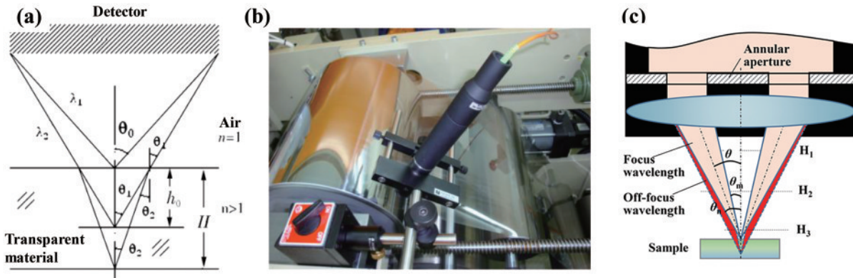
图 7 光谱共焦技术用于膜厚测量。(a)、(b)双层反射式 [58] ; (c)定入射角度式 [60]
