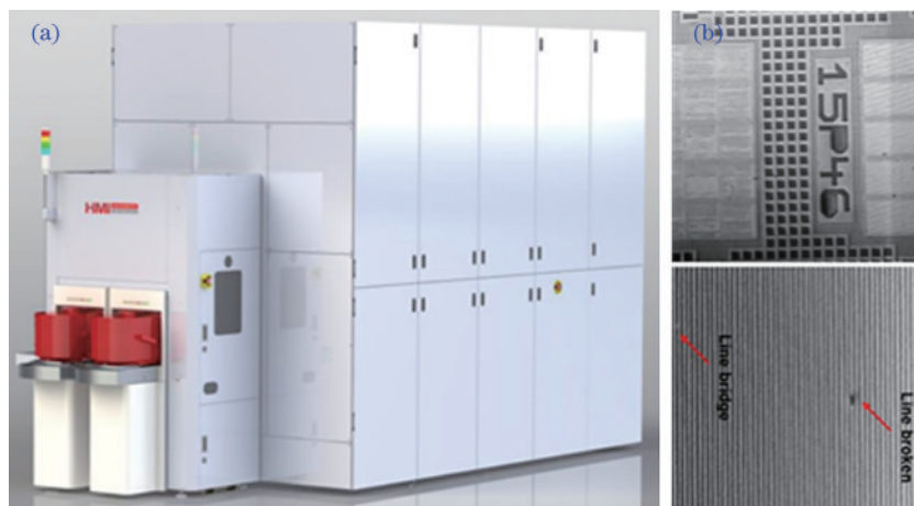
图 13 多电子束扫描缺陷检测系统。(a)HMI 集成的 MBI 系统;(b)上方为用于晶圆对齐的大视场 MBI 图像,下方为带有断线、桥接缺陷的 46 nm 间距周期线图像
