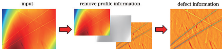
图 3 智能型面分析原理图
