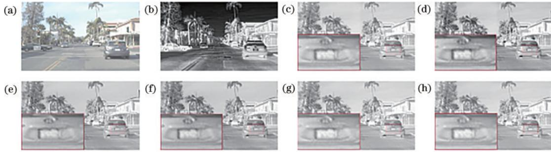
图 3 在 RoadScene 数据集上使用不同网络融合图像对比。(a)(b)源图像;(c) NestFuse;(d) NestFuse-HOG;(e) Res2Fusion;(f) Res2Fusion-HOG;(g) UNFusion;(h) UNFusion-HOG
