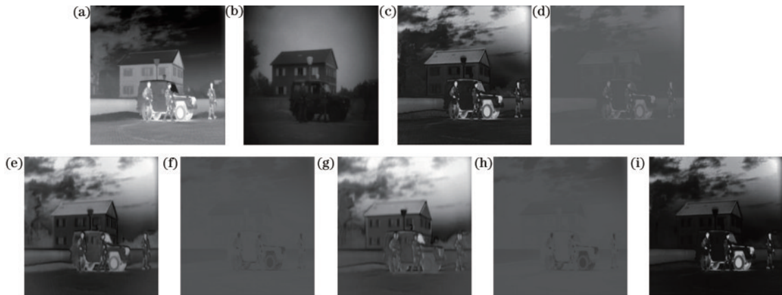
图 5 HAFF 模块特征及参数可视化。(a) IR; (b) VIS; (c) F_1 ; (d) \alpha ; (e) F_2 ; (f) \beta ; (g) F_3 ; (h) \gamma ; (i) F'
