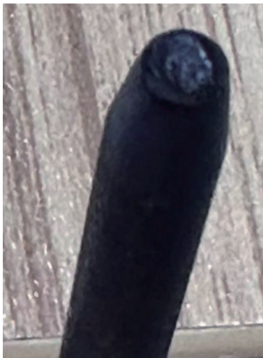
图 9 棒电极磨损图 Fig. 9 Rod electrode wear diagram
