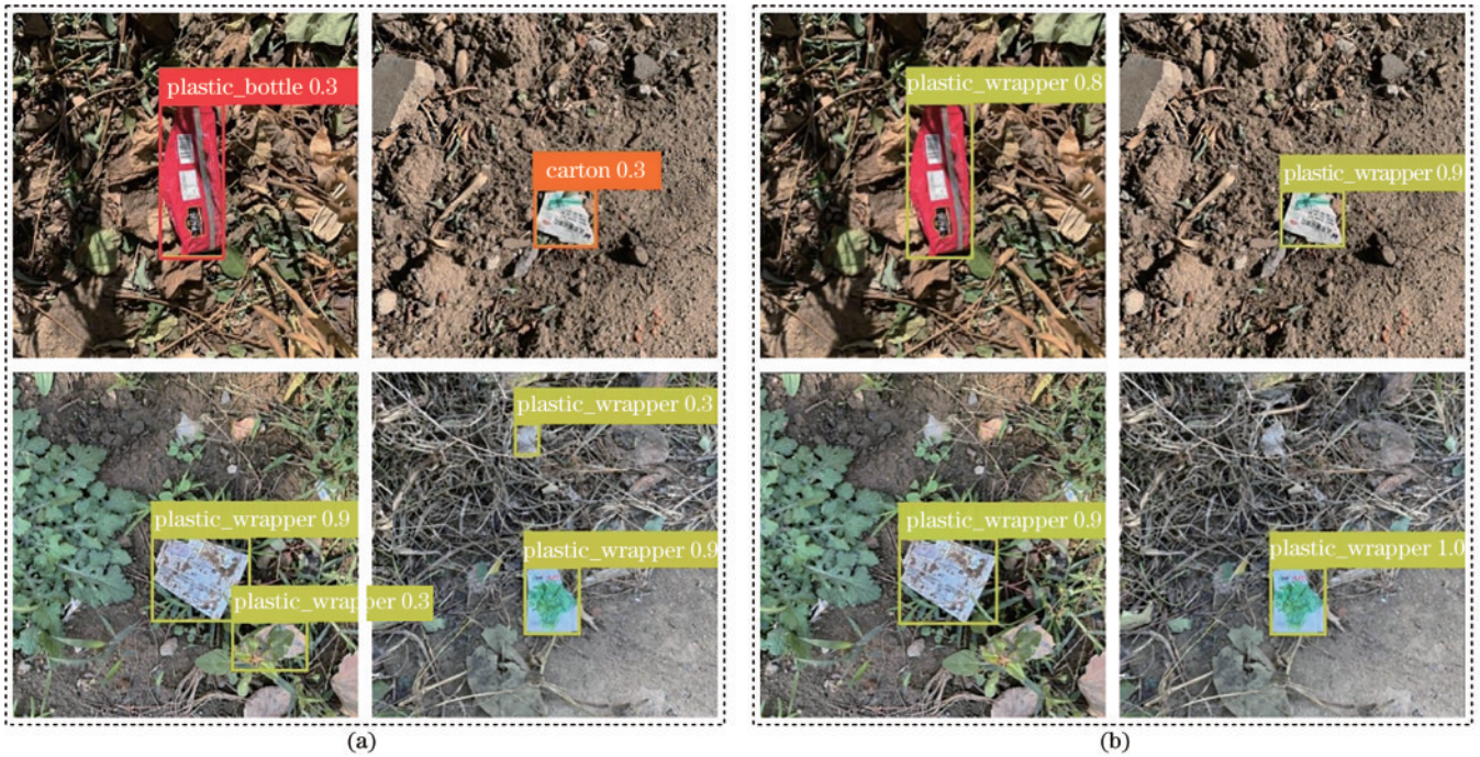
图 9 YOLOv5s 网络改进前后检测性能对比。(a)原 YOLOv5s 网络;(b)改进后的 YOLOv5s 网络
