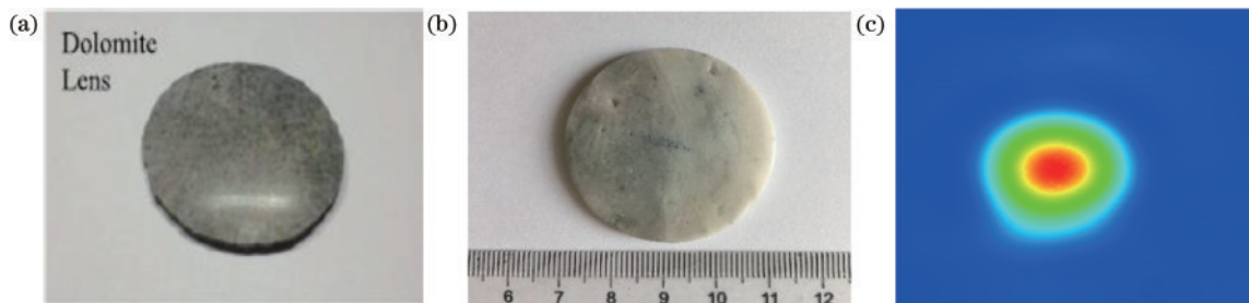
图 8 白云石制作的双凸透镜实物及聚焦效果。(a)天然白云石双凸透镜 [37] ; (b)白云石晶簇透镜 [38] ; (c)白云石晶簇透镜的聚焦效果 [38]
