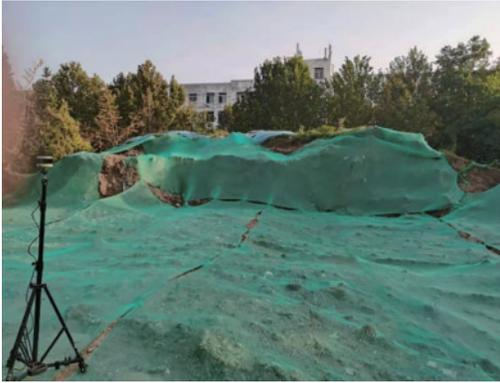
图 7 激光雷达采集点云数据
