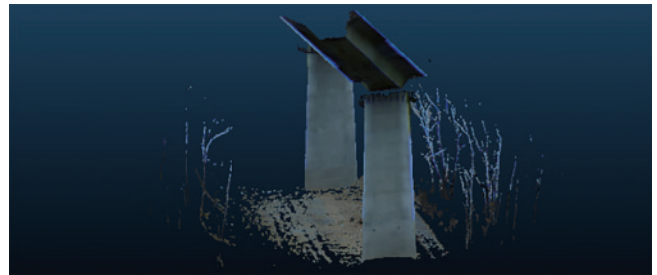
图 9 组合半径滤波结果(侧视图) Fig. 9 Combined radius filtering result (side view)
