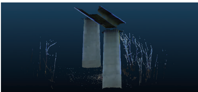
图 18 半径+颜色+法向的滤波结果 Fig. 18 Filtering result of radius+colour+normal
