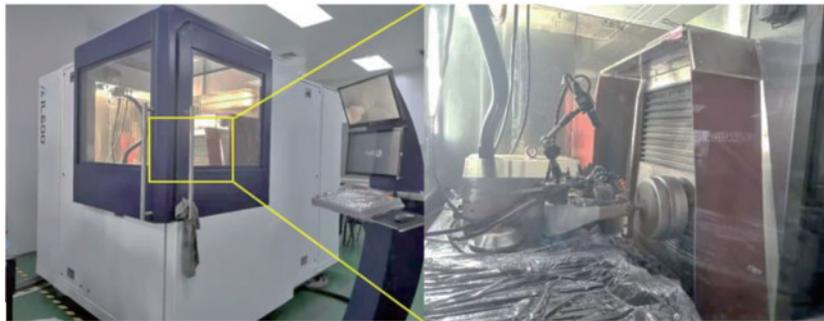
图 1 加工单晶锗所用的单点金刚车床
