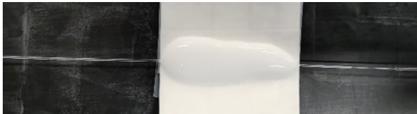
图 3 腐蚀光纤实物图
