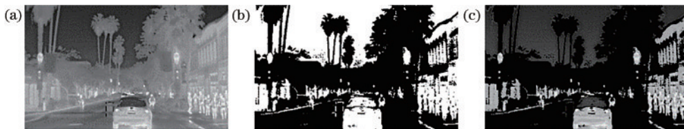
图 4 阈值分割结果。(a)红外图像;(b)显著图掩模 1;(c)红外子图像 1
