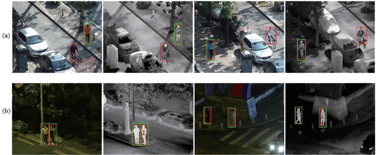
图 10 LLVIP 数据集下行人目标检测结果。(a)白天条件检测结果;(b)夜晚条件检测结果
