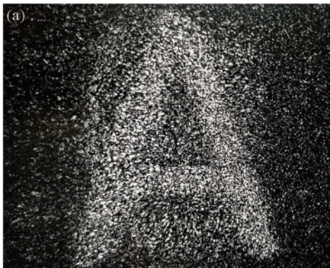
图 7 未消除散斑和杂散光时的像面。(a)存在散斑时的像面;(b)存在杂散光时的像面
