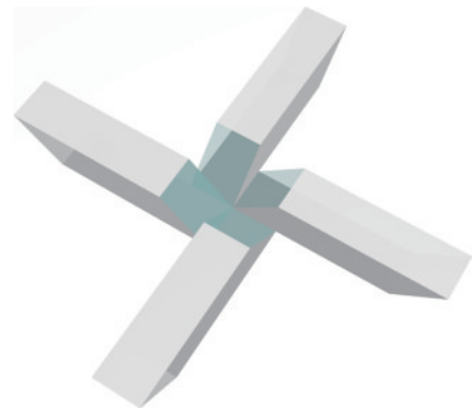
图1 4组斜方棱镜的排列示意图
