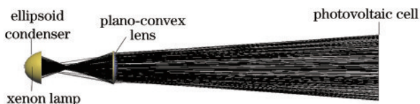
图 2 可见光无线传能系统的光学传输模型
