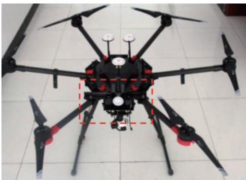
图 4 标识目标在无人机上安装效果 Fig. 4 Installation effect of identification target on UAV
