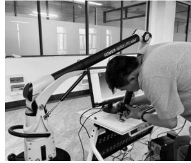
图 10 绝对关节臂测量机检测针尖高度的现场
