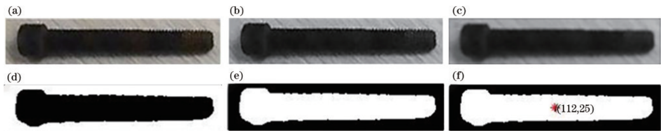
图 13 图像处理求取工件质心。(a)原图;(b)灰度化;(c)中值滤波;(d)二值化;(e)二值化取反;(f)质心求取
