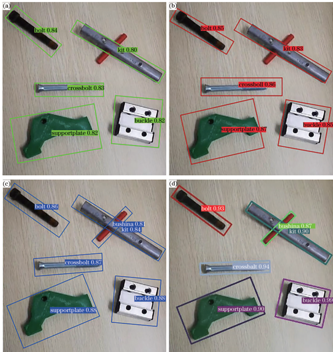
图 10 不同算法的工件检测结果图。(a)CAD-Net;(b)R 3 Det;(c)Gliding vertex;(d)GB-FRN-YOLOv5
