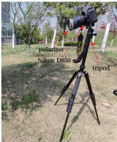
图 4 偏振成像装置
