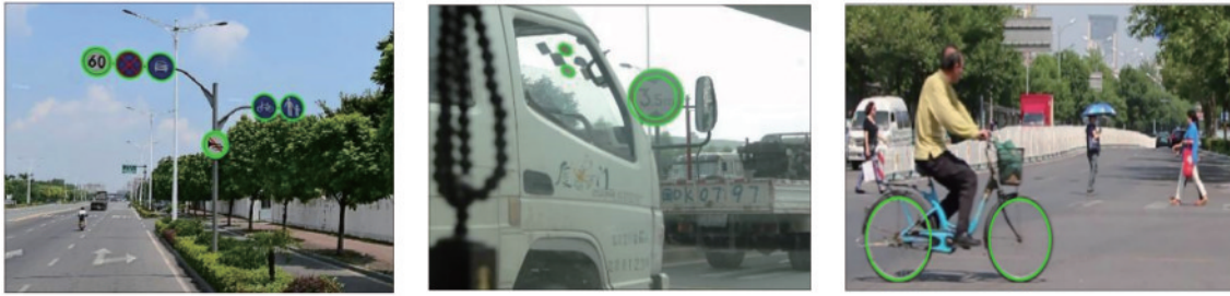
图 6 实拍图像的椭圆检测结果 Fig. 6 Ellipse detection results of real images
