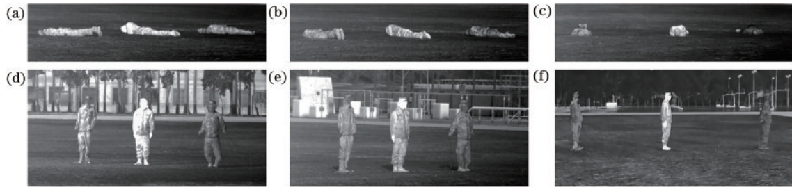
图 6 不同姿态和不同拍摄角度的目标红外图像。(a)(b)(c) 0°、45°和 90°方向拍摄的目标俯卧姿态图像;(d)(e)(f) 0°、45°和 90°方向拍摄的目标站立姿态图像
