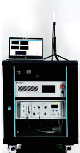
图 12 可搬运里德堡原子微波测量仪
