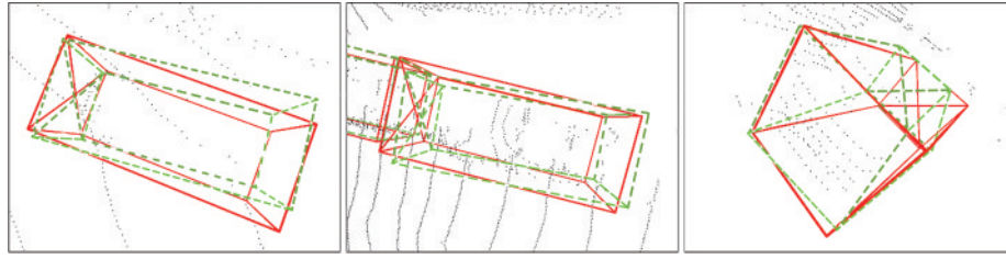
图 2 原版 PointPillars 检测可视化效果
