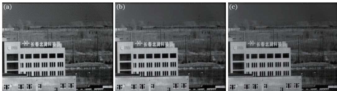
图 10 波前编码系统复原图像示意图。(a)0 倍离焦;(b)10 倍离焦;(c)20 倍离焦
