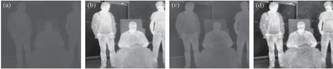
图 11 算法比较实验 4。(a)原图;(b)高斯高通型;(c) CLAHE;(d) 所提算法
