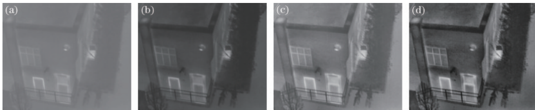
图 8 算法比较实验 1。(a)原图;(b)高斯高通型;(c) CLAHE;(d)所提算法
