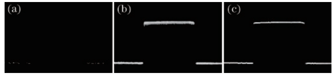
图 9 不同阈值法的分割结果。(a)极值法;(b)大津法;(c) P-tile 阈值法
