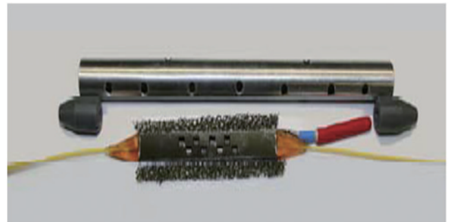
图 2 具有静压补偿功能的 DFB 光纤激光水听器 [5-6]
