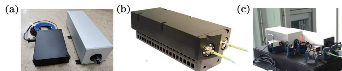
图 9 基于双声光调制的双频激光器实物图。(a)空间分离型;(b)一体化水冷型;(c)偏频锁定型
