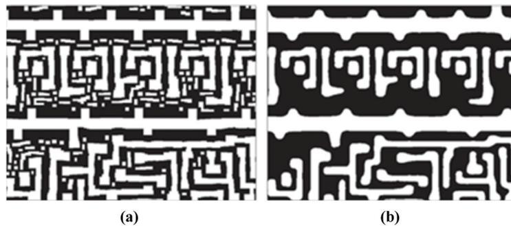
图 31 基于自适应核回归的快速 OPC 方法在 45 nm 金属层的仿真结果。(a)掩模修正图案；(b)优化后的光刻成像<sup>[49]</sup>
