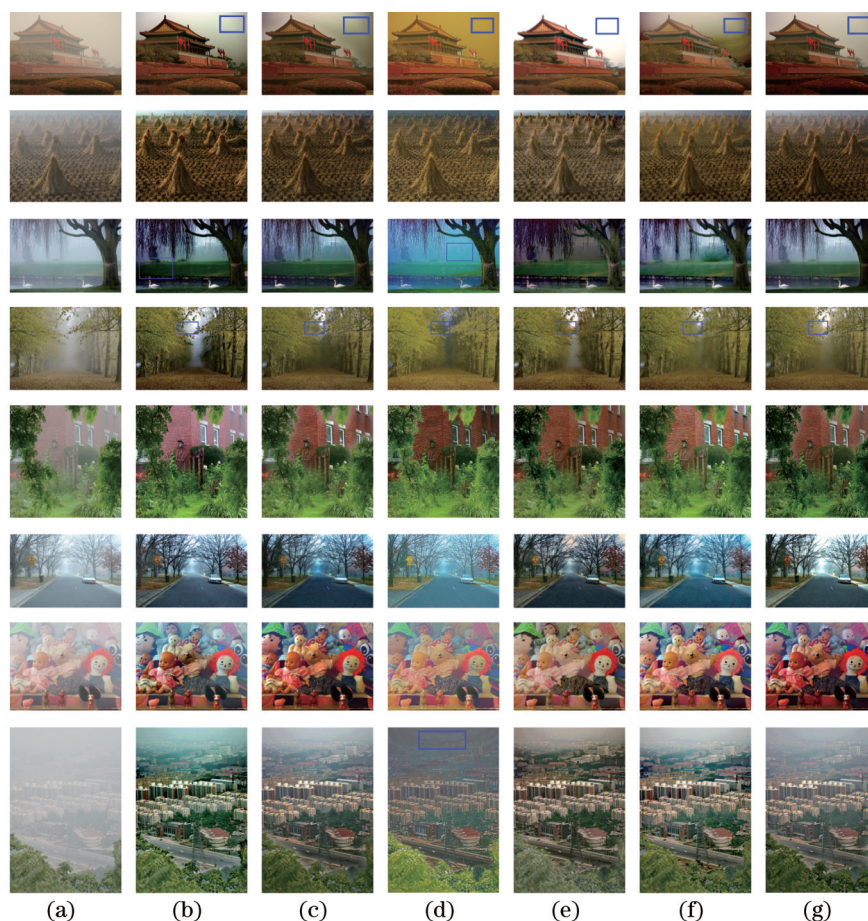
图 5 复原结果对比。(a)雾天图像;(b)文献[6-7]的算法;(c)文献[4]的算法;(d)文献[5]的算法;(e)文献[15]的算法;(f)文献[9]的算法;(g)所提算法
