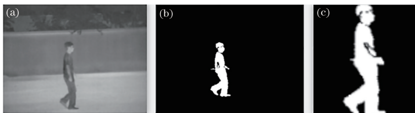
图1 原始红外图像和二值化后的人体轮廓图像。(a)原始图像;(b)二值化后的图像;(c)居中剪裁后的图像
