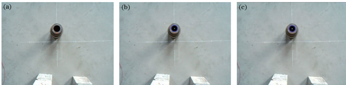
图 6 两种 Hough 变换方法检测到的圆形目标。(a) 原始图像; (b) 传统 Hough 变换圆检测; (c) 随机 Hough 变换圆检测
