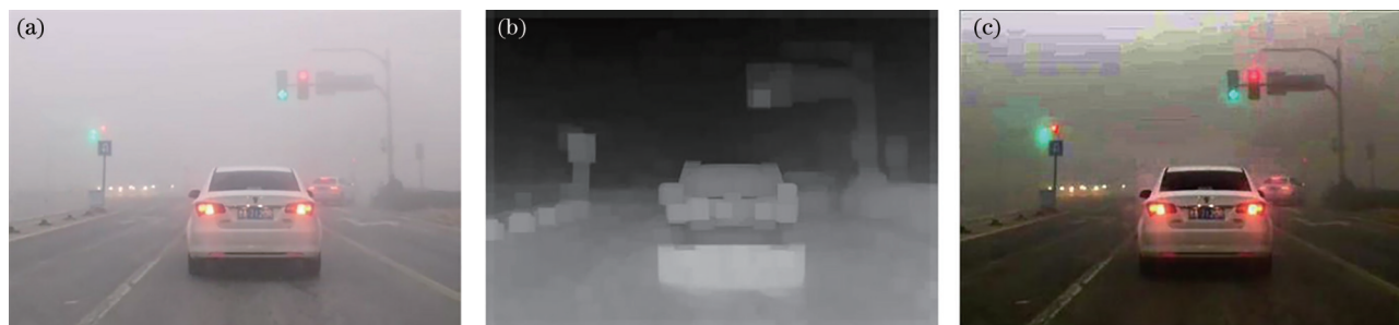
图 3 暗通道先验去雾。(a) 原图; (b) 透射率图; (c) 去雾后图像
