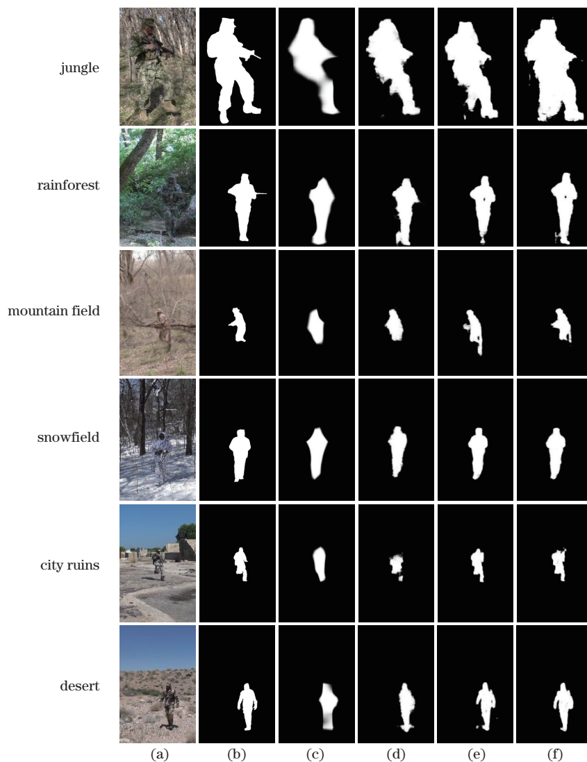
图 5 四种网络在 6 种复杂环境中的部分分割结果。(a)原图;(b)标注图;(c) FCN-8s 分割结果;(d) SegNet 分割结果;(e) U-Net 分割结果;(f) DESI-U-Net 分割结果
