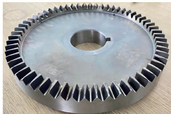
图 9 面齿轮的实验样品
