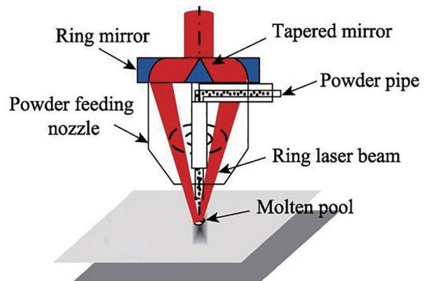
图 1 中空环形激光光斑产生机理<sup>[21]</sup>
