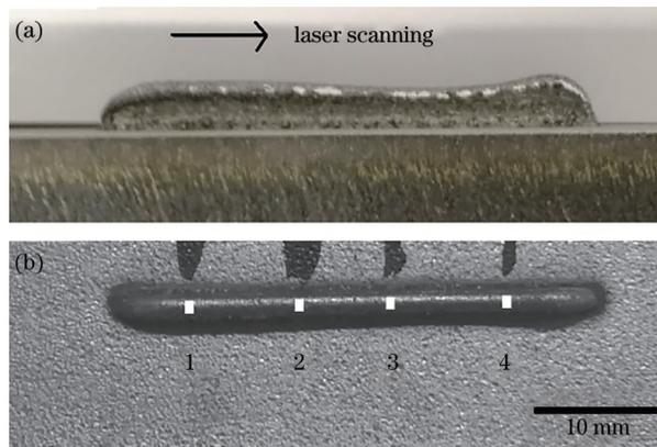
图 2 激光沉积成型件。(a) 正视图; (b) 俯视图
