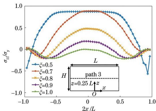
图 11 不同高度薄壁件的  $S_{11}$  沿路径 3 的分布Fig. 11  $S_{11}$  distributions along path 3 of thin-walled parts with different heights
